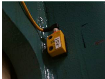
Kontrola stanu zamknięcia osłon ruchomych (PSEMag).
