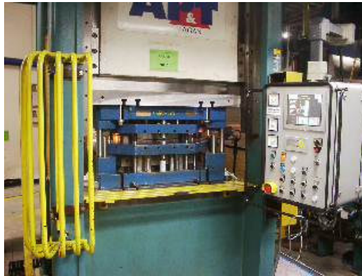
Pulpit operatora prasy z terminalami operatorskim i diagnostycznym (PMLmicro)
