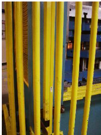
Kurtyna świetlna SOC4 (chroniona przed uszkodzeniami mechanicznymi) oraz wyłączniki krańcowe (ENK) max. górnej pozycji, min. dolnej pozycji, kontroli wybiegu i stanu zaryglowania suwaka prasy w max. górnej pozycji.
