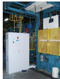
Kontrola stanu zamknięcia osłon ruchomych (PSEMag).
