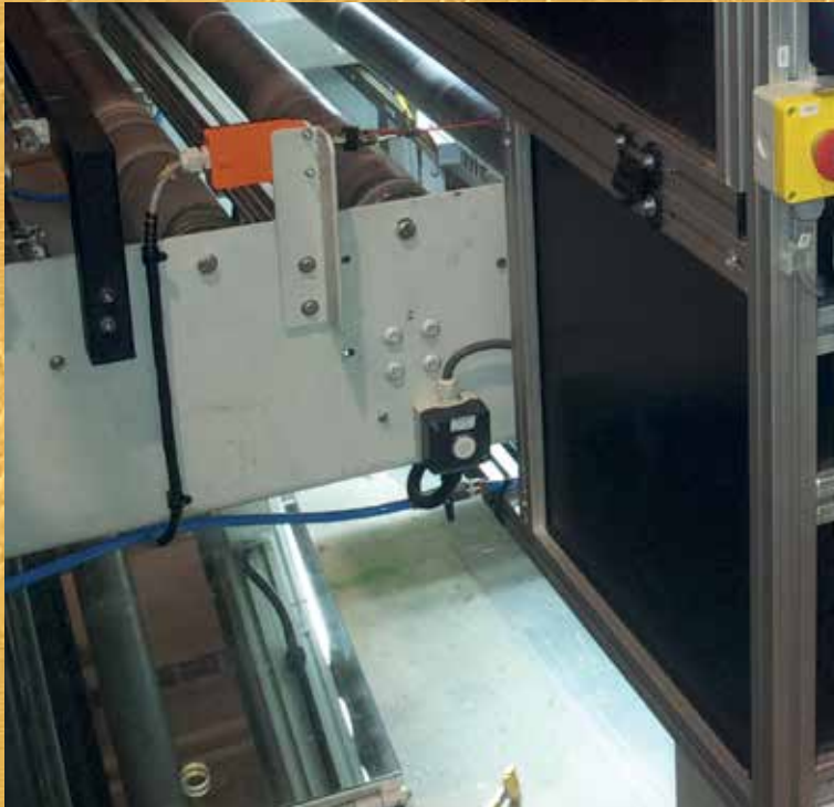
Die Inspektionsanlage sammelt per 2-GigE-Flächenkamera Analysedaten, um die Qualität der Laminierung zu prüfen.
